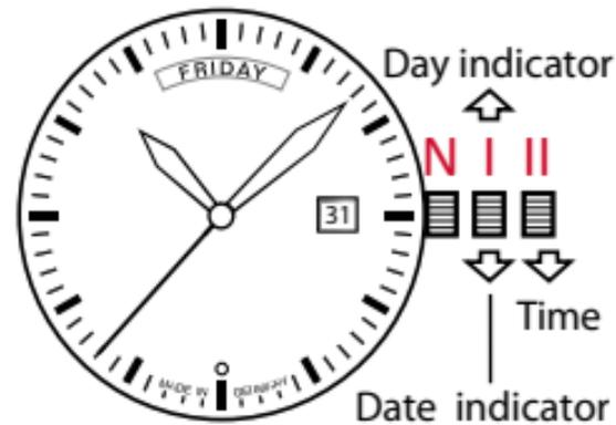
**BEMERKUNG:** Wenn die Uhr steht, d.h. nicht aufgezogen ist, muss sie vor dem Tragen zum halben Aufzug (ca. 15 Drehungen im Uhrzeigersinn in Nullstellung [N]) aufgezogen werden. Der Restaufzug der Automatik-Uhr erfolgt durch die Armbewegung beim Tragen.
